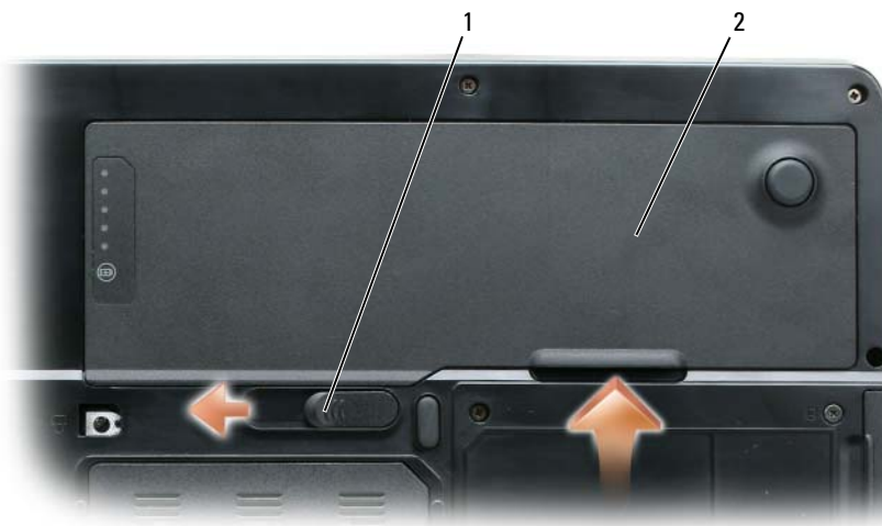
1 loquet de fermeture de la baie de batterie 2 batterie
